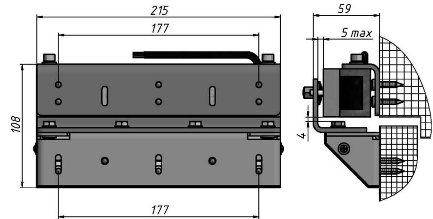
Рисунок 2 - Габаритный чертеж комплекта МК AL-350FB-M-03
