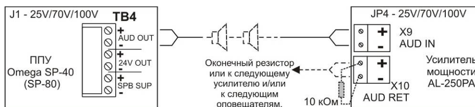
Рис.7а Пример подключения к ППУ Omega SP40/2 (SP-80).
