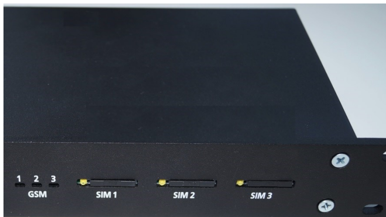
Рис. 5.1. Держатели SIM-карт (нажмите желтую кнопку для извлечения фиксатора)
