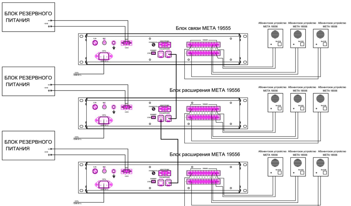
Блоки связи и расширения соединяются между собой кабелями, входящими в комплект блока расширения. Блоки БРП подключаются проводами сечением не менее 0,5 мм<sup>2</sup>
