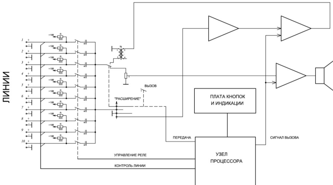
В состав блока входят плата коммутации (с выходными реле), плата кнопок и индикации и плата процессора.
