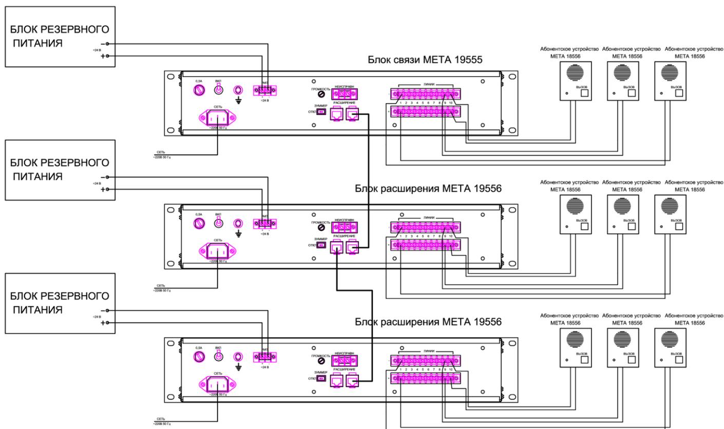
Блоки связи и расширения соединяются между собой кабелями, входящими в комплект блока расширения. Блоки БРП подключаются проводами сечением не менее 0,5 мм<sup>2</sup>
