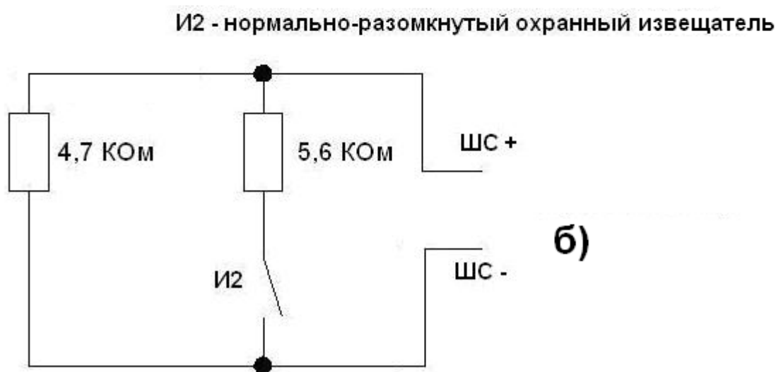
Рис 13. Подключение нормально замкнутого или нормально разомкнутого извещателя с возможностью контроля обрыва и КЗ
