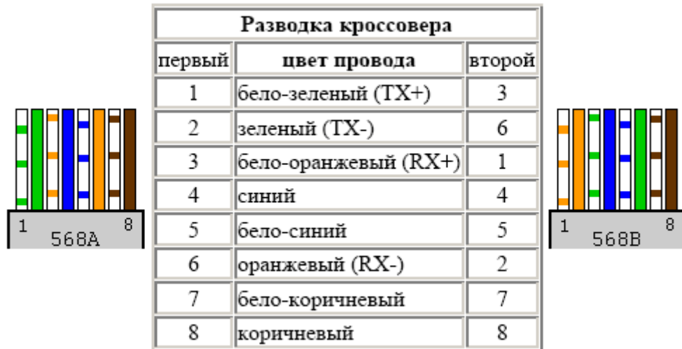
Рис. 5. Разводка кроссовера
