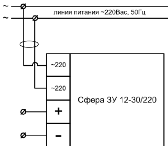
Схема подключения оповещателя Сфера 3У 12-30/220 уличное исполнение; питание переменным током. Напряжение питания 220^{+10\%}_{-15\%} , 50Гц.
