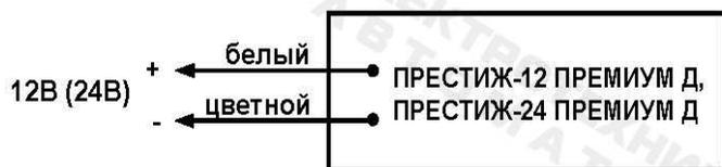
Рис.1. Схема подключения.
