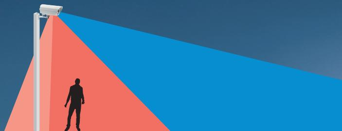
Во всех моделях серии применено уникальное решение: специальный встроенный датчик, не только полностью закрывает «мертвую зону» перед извещателем, но и контролирует подступы со всех сторон.
