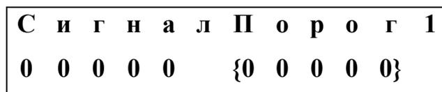
Окно предназначено для отображения текущего сигнала на ВЧЭ и установки порога обнаружения.
