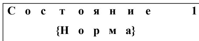
Окно служит для отображения состояния входа. Параметр изменяется автоматически в зависимости от состояния текущего входа и может принимать следующие значения:
