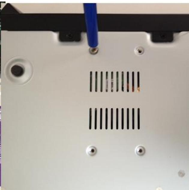
5. Зафиксируйте HDD и закройте корпус
