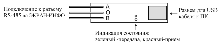
Рисунок 6. Расположение контактов преобразователя ПИ1.
